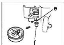
Čištění usazovací nádrčky
