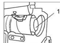
Čištění vzduchového filtru
